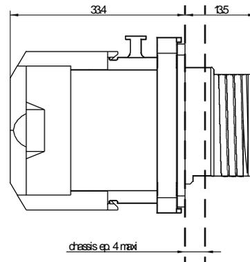
Cette prise est équipée d'un système de contacts autodénudants permettant un câblage en moins d'une minute. La connexion se fait par paires, sans outil et autorise plusieurs connexions / déconnexions tout en garantissant la tenue mécanique des fils. Des conducteurs de jauge AWG22 et 24 monobrin sont acceptées.
